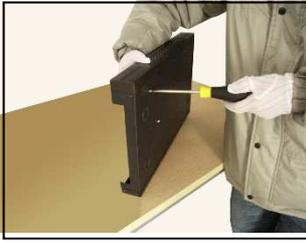
② fissare la vite del disco rigido
